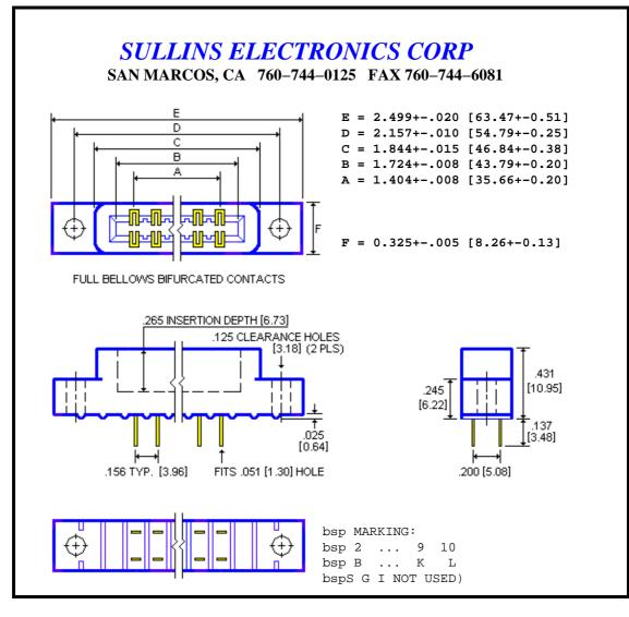
1.0 SPECIFICATIONS FOR A DUAL 10/20 POSITION EDGECARD CONNECTOR
